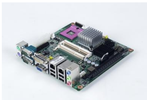
3.17.ábra: A mérőberendezésbe épített AIMB-258 típusú mikro alaplapp (bal oldali kép) és NI PCIe 6251 típusú mérésadatgyűjtő kártya (jobb oldali kép)
