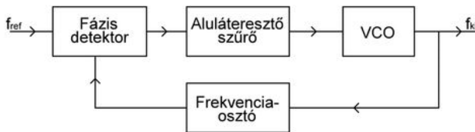
4.8 ábra: PLL áramkör felépítése [83]
