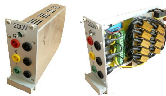
3.15. ábra: Hall-elemes 200V-os feszültségmérő modul
