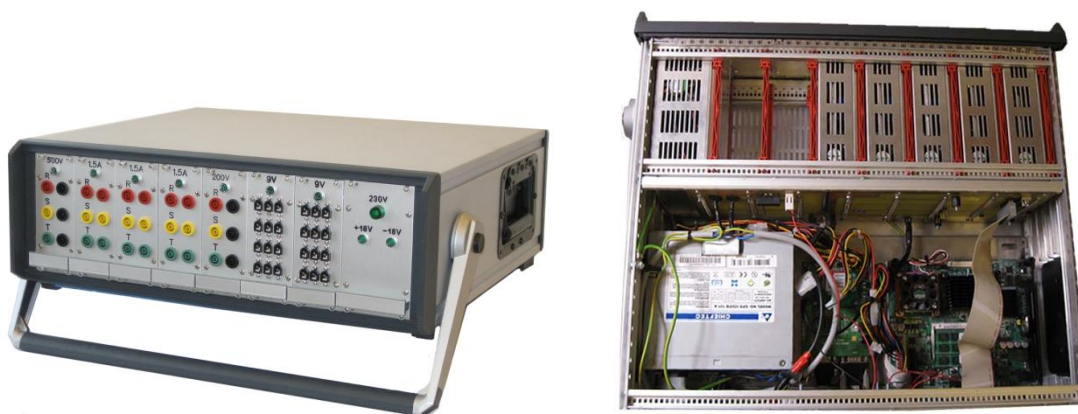
3.18. ábra: A kifejlesztett számítógéppel rendelkező komplex hálózatanalizáló berendezés külső és belső nézete
