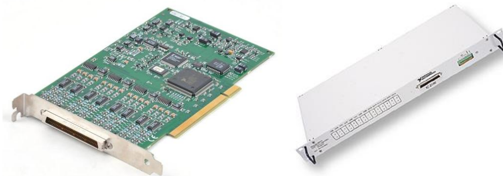
8.2. ábra: NI PCI 4351 típusú hőmérsékletmérő kártya és a TC-2190 hőelem modul
