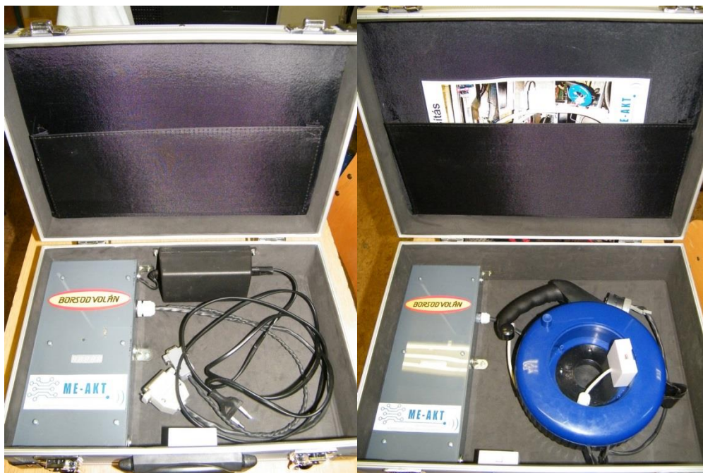
4.23. ábra: CAN/Ethernet konverter alapú prototípus
