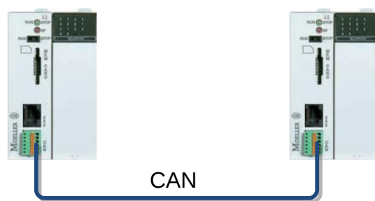
4.9. ábra: Két PLC összekötése CAN hálózaton
