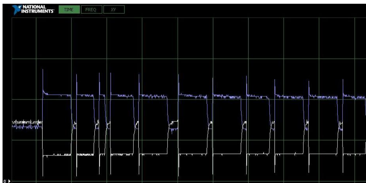
4.13. ábra: CAN jelalak lezáró ellenállás nélkül
