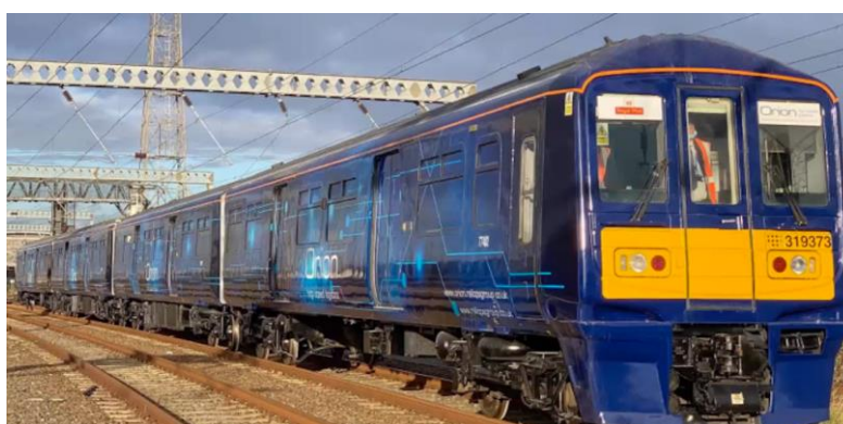
36. ábra ORION osztott hajtású áruszállító vonat 54
